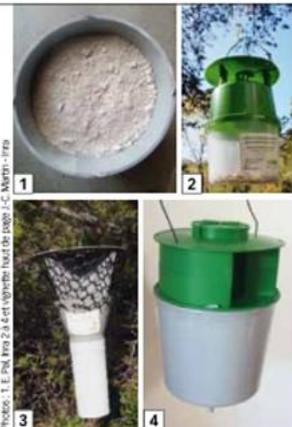
Fig. 1 : Pièges installés sur le dispositif 2017 en forêt domaniale du mont Ventoux : 1. Piège Procerex rempli avec de la terre de diatomée Rampa'Clac (Protecta). 2. Buxatrap. 3. Mastrap L. 4. Procerex
